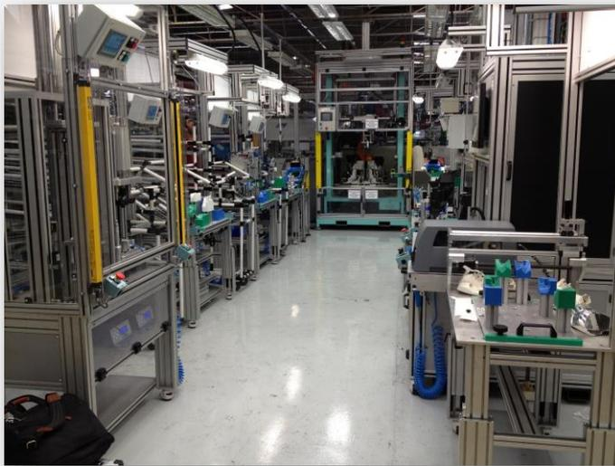
Le linee possono essere realizzate con più banchi singoli specializzati, oppure con la logica delle linee continue palettizzate. Nel primo caso (banchi singoli) normalmente ci sono più operatori, ogni banco esegue una operazione di assemblaggi componenti e l'ultimo esegue il controllo finale sul pezzo finito. Normalmente ci sono più operatori.
